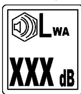
Das Etikett gibt den garantierten Geräuschpegel entsprechend der EC-Richtlinie 2000/14/EC an. Den korrekten Geräuschpegelwert finden Sie unter „Technische Daten“.
